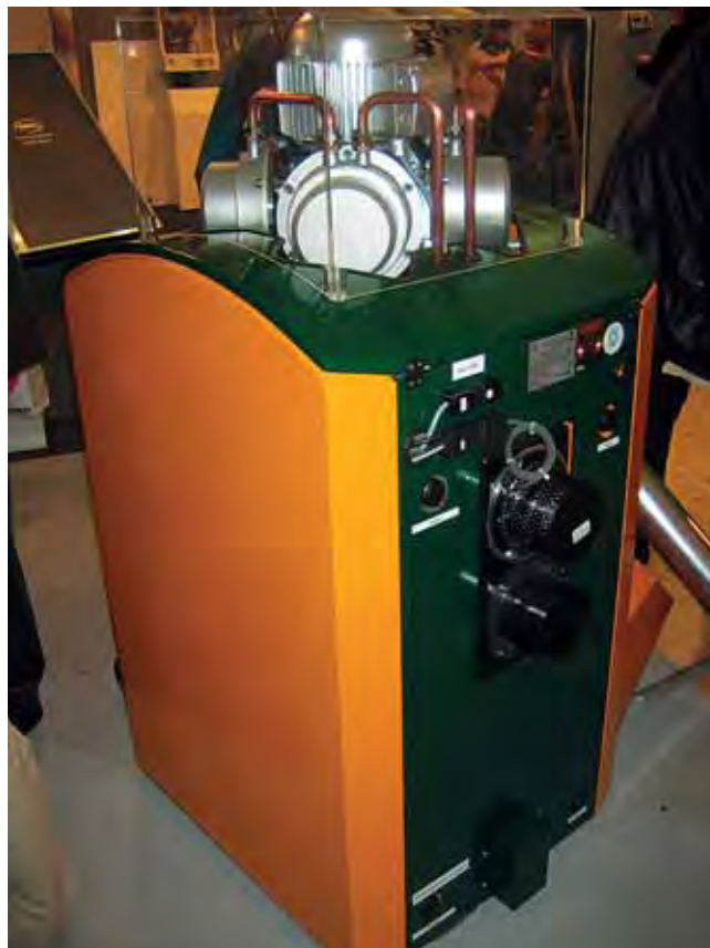
> Pelletsbefeuertes SPM-Stirlingmotor, 1 kW el, evtl. ab 2008 am Markt. ([9])
